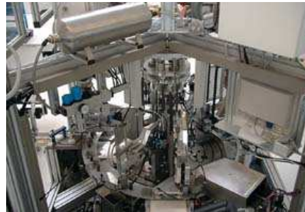
Rundtaktautomat mit 12 Stationen, 1-fach Nutzen Handlingseinheiten nockengesteuert
