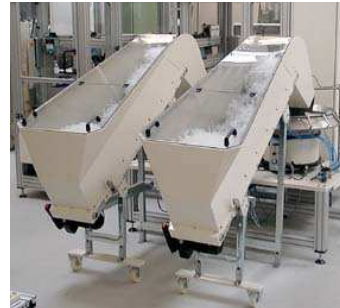
Füllbunker mit Stollenband, Schütte und Klappeckel
