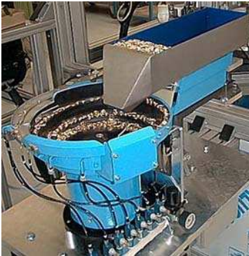
Schwingförderer mit Stufentopf, polyurethanbeschichtet, Ordnungselemente aus CrNi-Stahl
