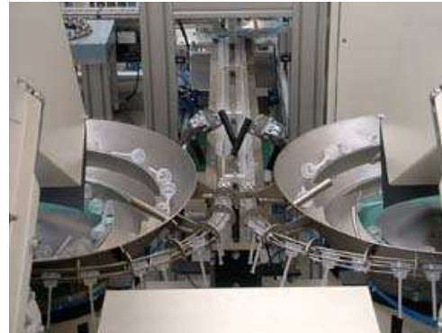
Schwingförderer mit konischem Topf und Steuergerät gefertigt aus CrNi-Stahl, ohne Beschichtung, glasperlgestrahlt
