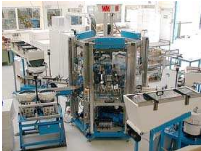
Rundtaktautomat mit 24 Stationen, 2-fach Nutzen
